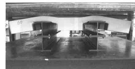
写真7 圧縮強度試験
