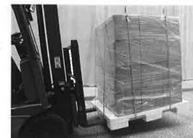
写真1 EPSパレット(フォークリフトタイプ)とその使用例 ストレッチフィルムで積み荷とパレットを固定し、PPバンドと接する部分には紙アングル(角当て)を付けている。
