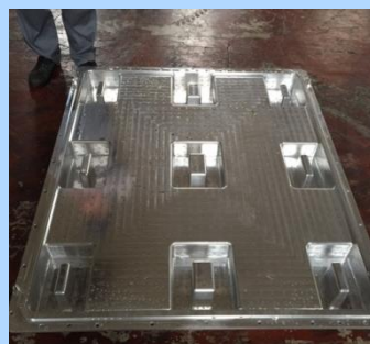
●EPSパレットの金型～金型は内製で、設計から製作まで手掛けています。
