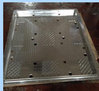
●EPSパレットの金型～金型は内製で、設計から製作まで手掛けています。
