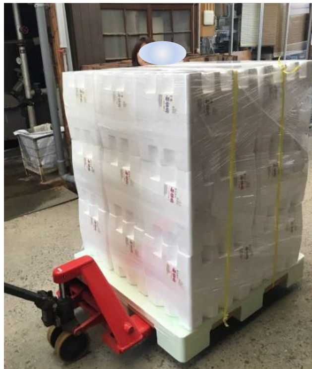
『EPSパレット』をハンドリフトで 移動させます。強度に問題はありません。
