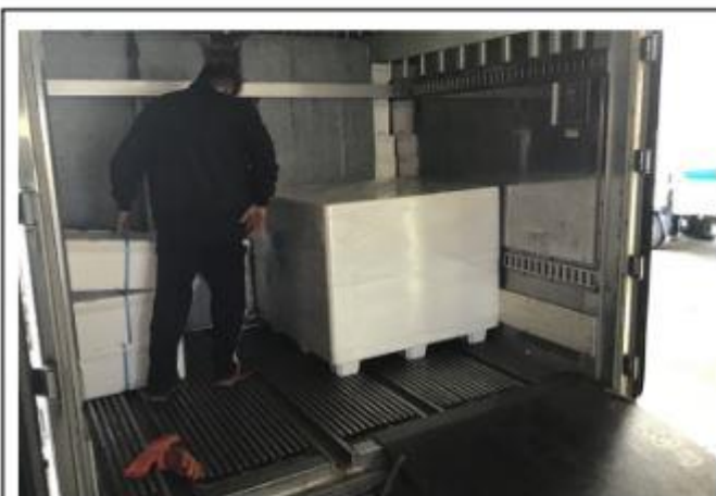
冷蔵車内での冷凍輸送 5℃の冷蔵車内で-5℃を16時間維持
