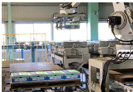
① パレタイザーで木製パレットに積み込みされる荷物
